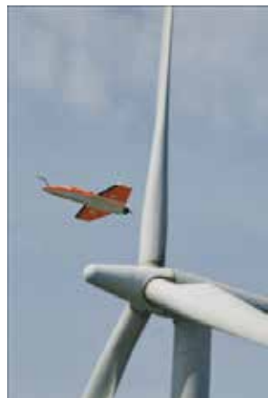
Fig 1. Det lille fjernstyrede fly med diverse måleinstrumenter ved Nøjsomheds Odde. Foto: Jesper Hjelme, IWAL
