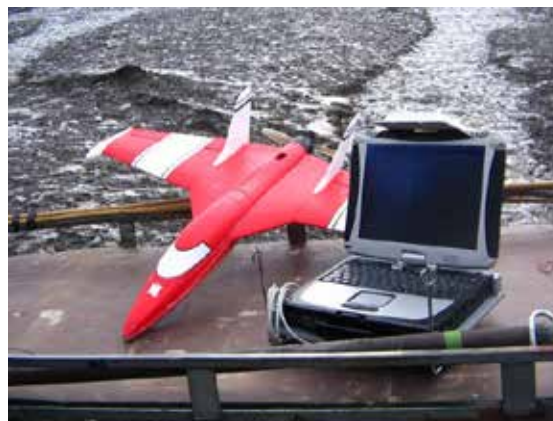
Fig.3. Det ubemandede SUMO-fly og pc'en der blev brugt som kontrolstation på land. Flyet er 75 cm langt og har et vingefang på 80 cm.
